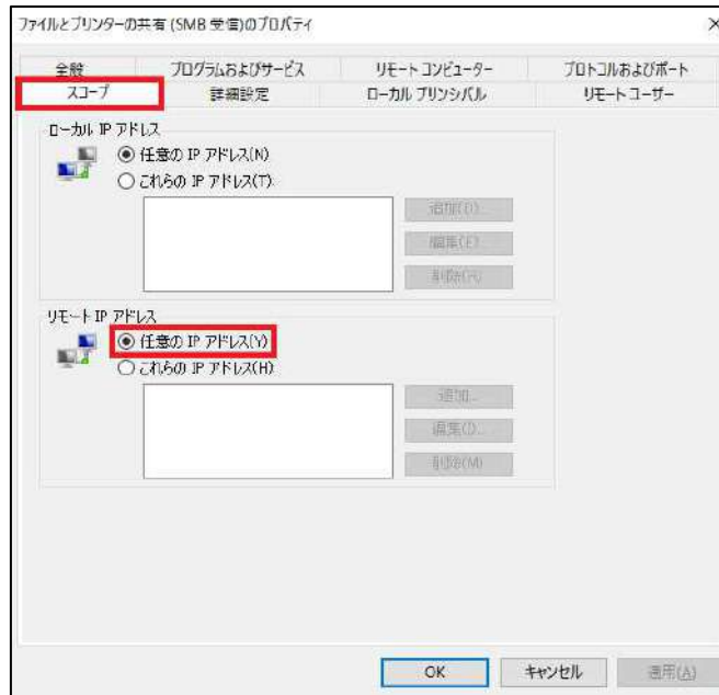
図419 ファイルとプリンターの共有 (SMB受信) - 任意のIPアドレス設定
